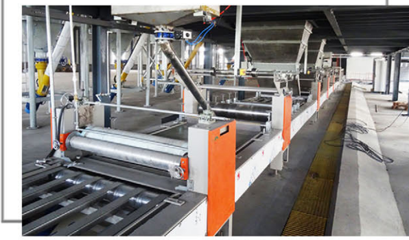
۴. شکل دهی ورق 4. Forming line
