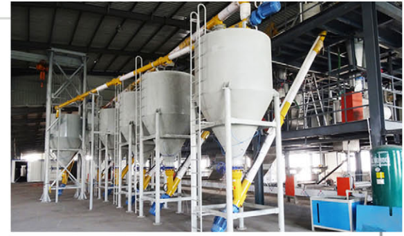
۱. اندازه گیری و هدایت اتوماتیک مواد 1. Automatic dosing & feeding system
